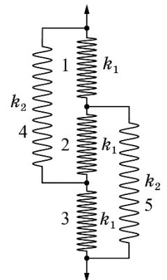
**Возможное решение.** Пусть удлинение пружин 1 и 3 равно  $x$  (из симметрии следует, что удлинения одинаковы), а пружины 2, соответственно,  $y$ . Тогда пружины 4 и 5 растянуты на  $x + y$ . Рассмотрим силы, приложенных к точке соединения пружин 1, 2 и 5:
